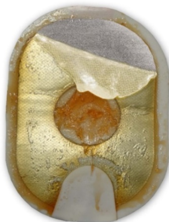
Bild 2: Separerad, vikt gel kan också ha ett missfärgat eller smält utseende.
